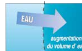
Membrane SEMI-PERMÉABLE (perméable au solvant, imperméable au soluté)
